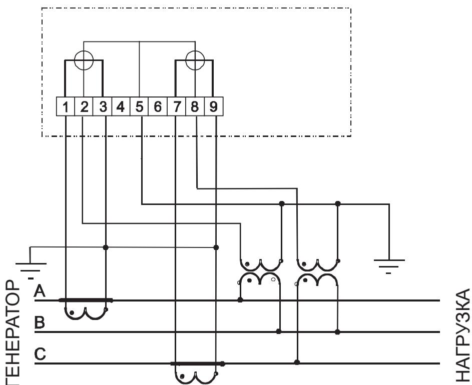
Рисунок 12.8 – Схема включения двухэлементного счетчика в трехпроводную
