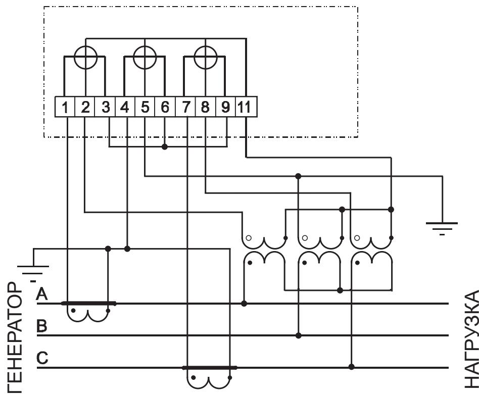
Рисунок 12.7 – Схема включения трехэлементного счетчика
