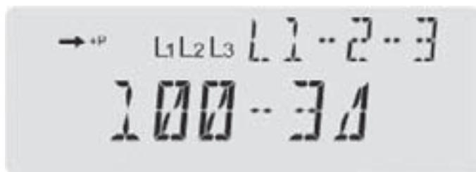
Рисунок 9.4 – Трехпроводная сеть с номинальным напряжением 100 В
