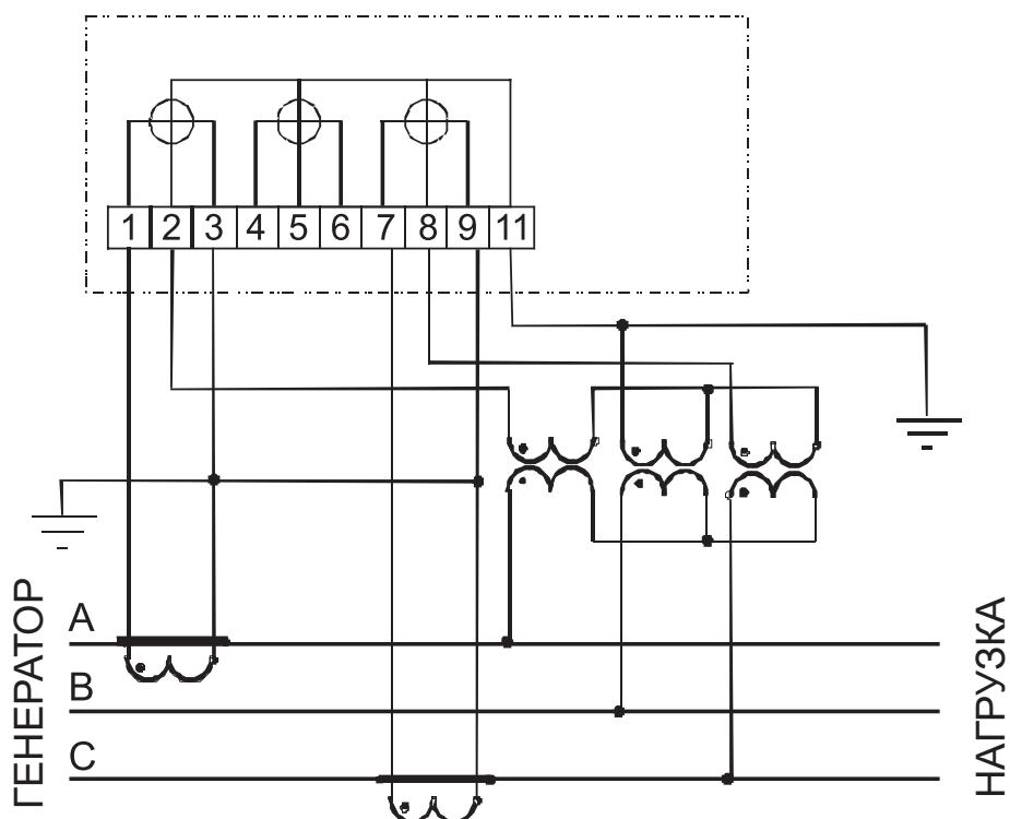
Рисунок 12.5 – Схема включения трехэлементного счетчика
