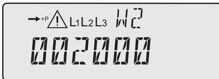
Рисунок 10.3 – Отображение кода предупреждения “W2 002000”
