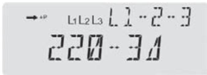
Рисунок 9.5 – Трехпроводная сеть с номинальным напряжением 220 В
