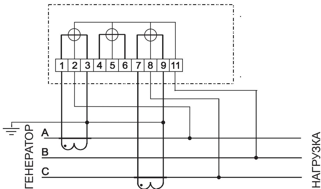
Рисунок 12.6 – Схема включения трехэлементного счетчика в трехпроводную
