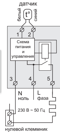
Схема 1. Упрощенная внутренняя схема и схема подключения
