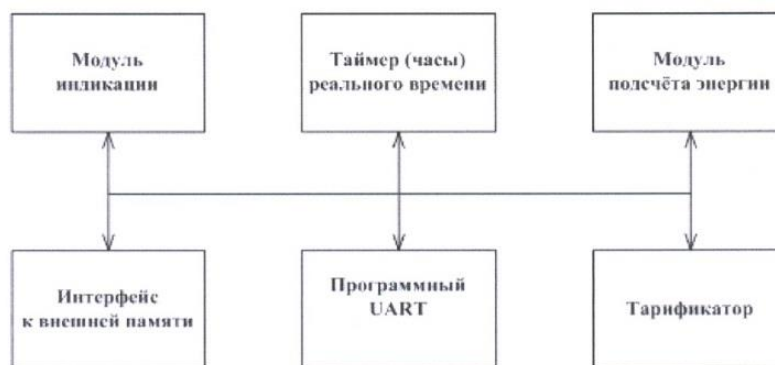
Рисунок 7 - Структура программного обеспечения «Меркурий 231»
